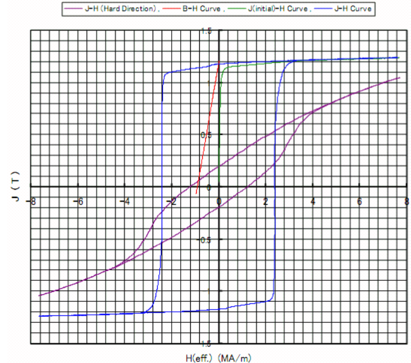
図4 ネオジム焼結磁石のJ-Hカーブの磁気異方性
