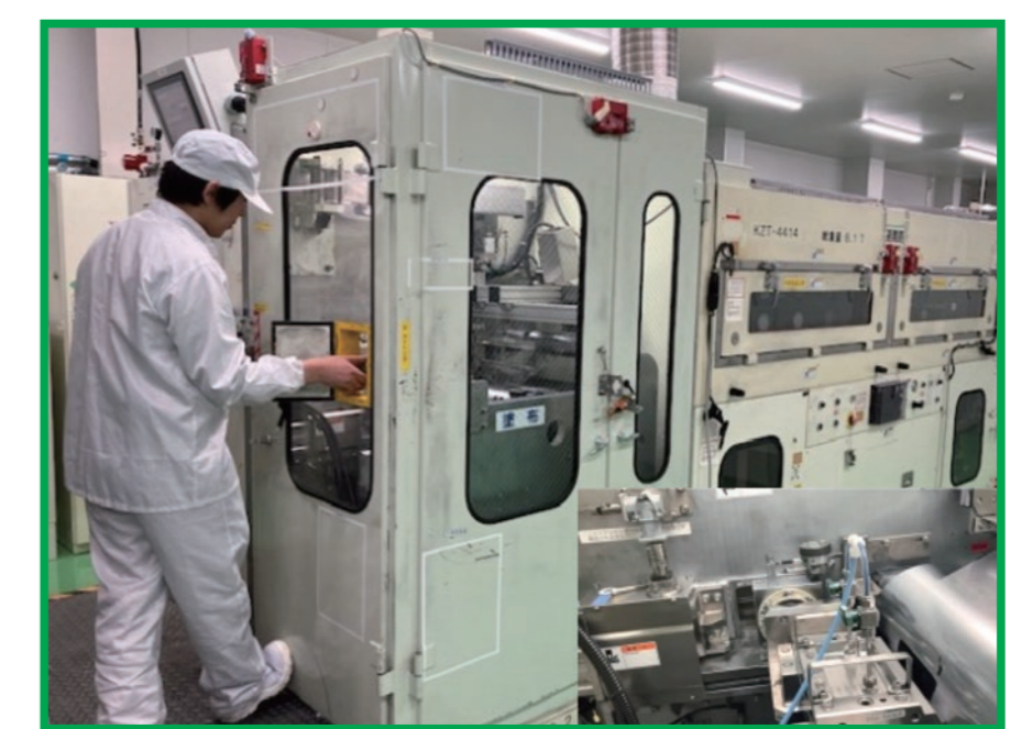
触媒インク分散・塗工の作業風景
