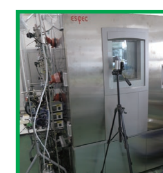
大型恒温槽 内容積:800L 温度:-70℃~100℃
