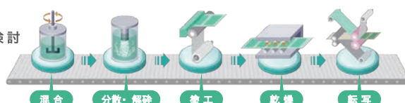
燃料電池 / 電解デバイスの電解質膜への量産化工程イメージ
