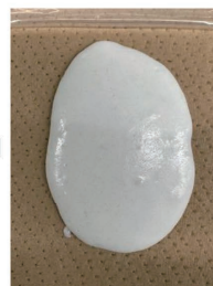
図2 シリコンゴム : \text{Al}_2\text{O}_3 = 60 : 40 (vol%)の複合体
