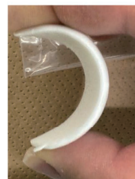
図2 シリコンゴム : \text{Al}_2\text{O}_3 = 60 : 40 (vol%)の複合体
