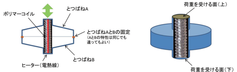
凸ばね/ポリマーコイルアクチュエータユニット概念図
