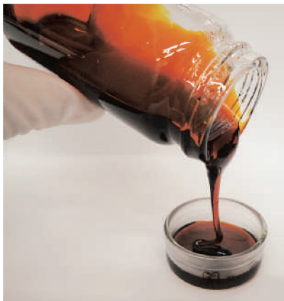
新しい溶解法によるアラミド樹脂溶液は流動性が高く成形しやすい
