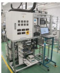
KRI（京都市下京区、川崎真一社長）は、二酸化炭素（CO<sub>2</sub>）を吸収し分離できる評価ができる装置（写真）を開発した。CO<sub>2</sub>吸収量や材料の耐久性などを高湿度といった実環境に近い状態で評価できる。大気中のCO<sub>2</sub>の直接回収（DA）技術の実用化が、DACの研究開
