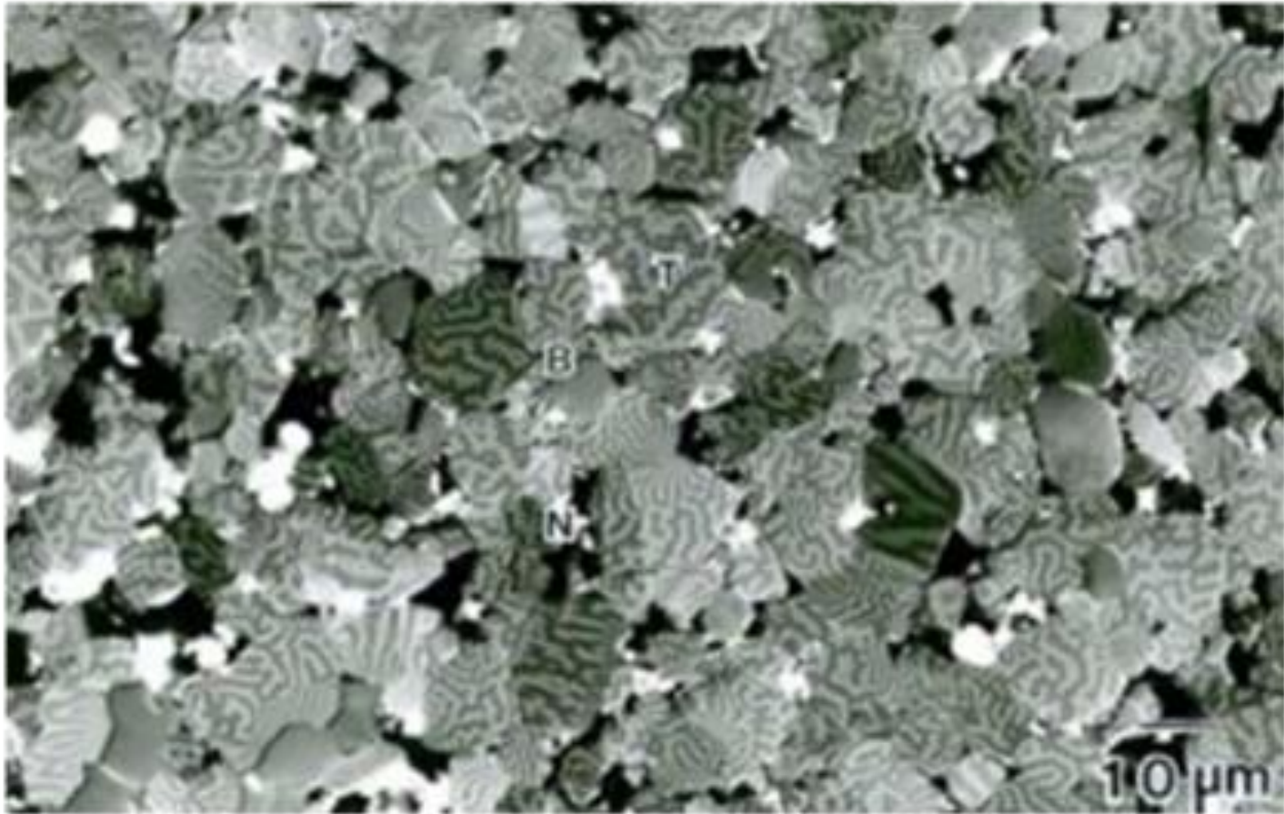
\text{Nd}_{15}\text{Fe}_{77}\text{B}_8 磁石 消磁状態 (c 面)
